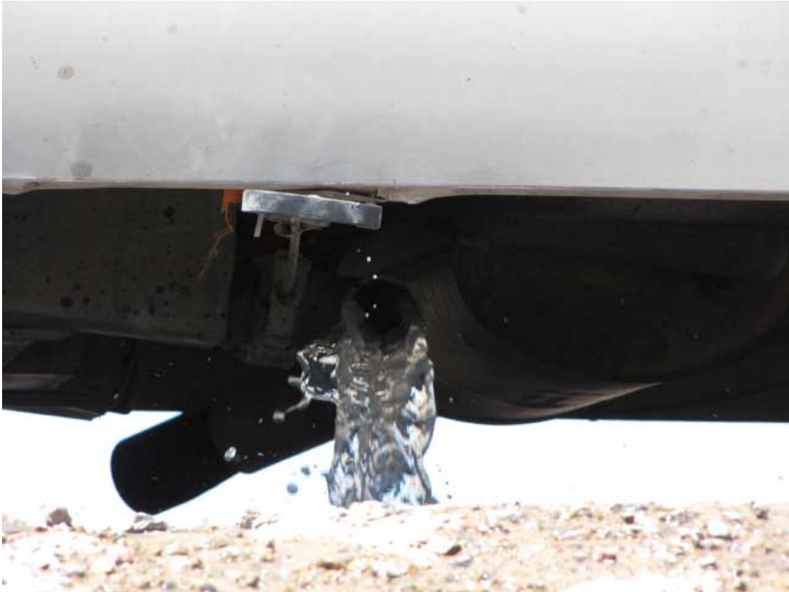
Vaciado de grises. Se puede apreciar el estropicio de la varilla y la cincha naranja que la sujeta
